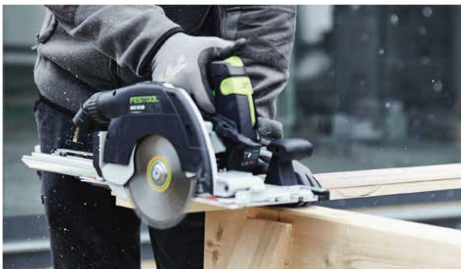
Schnelles, präzises Sägen dank Kappschiene.
