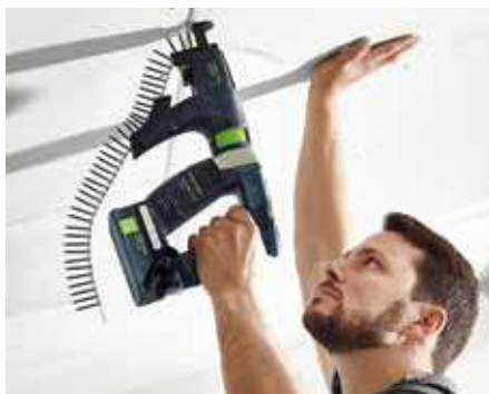
Präzise Einschraubtiefe dank Einschraubautomatik.
