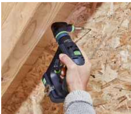
Die Tiefenanschläge und der Exzentervorsatz ermöglichen zusätzlich tiefenbegrenzt und randnahes Schrauben.
