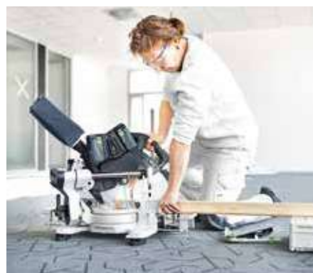
Die Zusatzfüße erhöhen den Arbeitstisch der KSC 60 exakt auf die Höhe des Systainers SYS 3 M 112 bzw. SYSTEMAINER SYS 1
