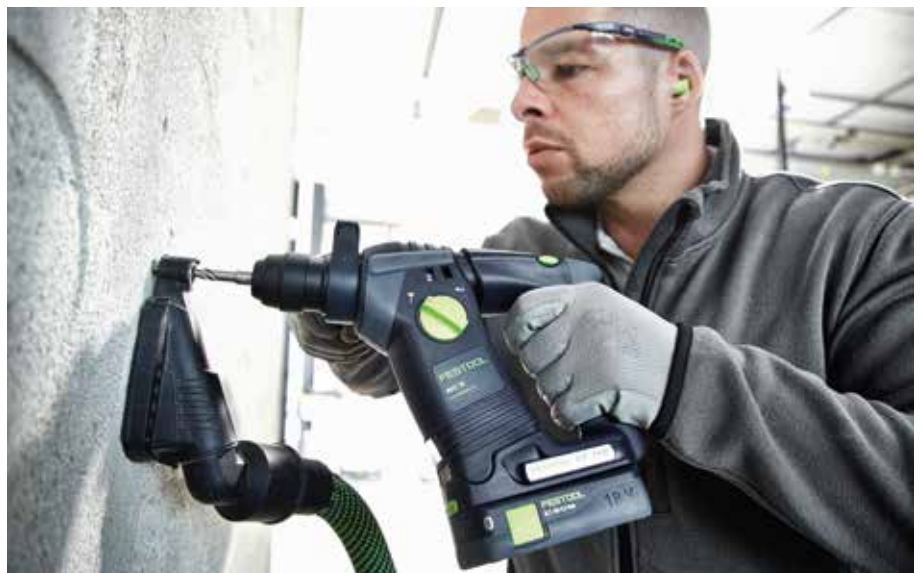
Kräftechonend Bohren dank Vibrationsdämpfung. Kein Übertrag der Schlagenergie auf die Hände.
