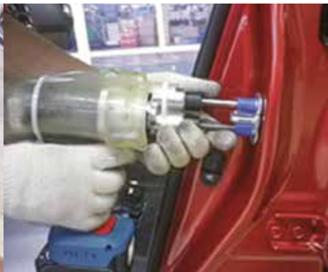
Installation von Türschließern
