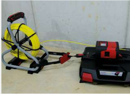
RM35 mit Montageplatte-Systemkoffer, Glasfasereinziehsystem Ø 4,5 mm
