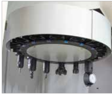
16-fach Werkzeugwechsler S 400
