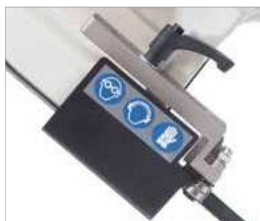
Lösen und Verstellen der Spann- lager mit einer Hebelndrehung
