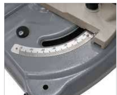
Gut ablesbare Winkelskala - einfache Gehrungseinstellung 0 bis 60°
