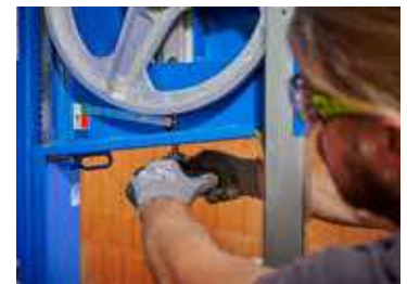
Sägebandwechsel in kürzester Zeit möglich. Die Maschine stoppt sofort wenn eine der Türen geöffnet wird.
