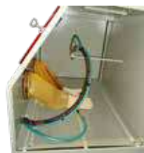
PAL Innenraum (Injektorsystem)
