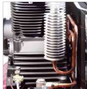
Kühler aus Alu- Druckguss und Kupferkühlleitung
