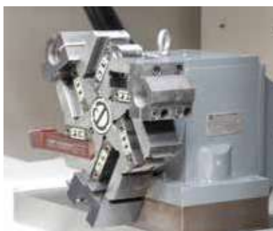
6-fach Werkzeugrevolver serienmäßig
