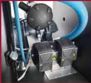
Schalldämmhauben-Heizung: Für Anlagen bei niedriger Umgebungstemperatur
