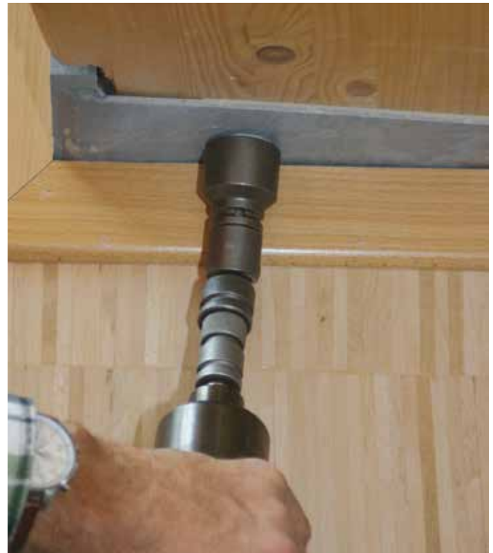
In schwierigen Einbaulagen helfen ASW-Kugelgelenke weiter ASW adapter, with swivel head, helps in difficult applications
