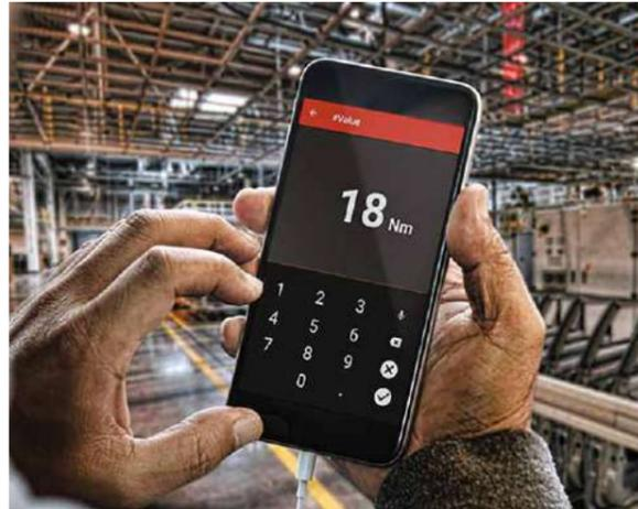
Über die INSIGHT™ Connect-App bleiben Sie produktiv, mobil und behalten die Kontrolle über Ihren Befestigungsprozess. Sie programmieren jedes Ingersoll Rand® QX Connect Series™-Tool ohne zusätzliche technische Schulung, eine spezielle Software, Berechtigungen für das Anlagennetzwerk oder einen Laptop. Bediener können mit Hilfe der App Drehmoment und Drehwinkel für die mit Messwertgeber ausgestatteten Werkzeuge schnell über ein Smartphone oder Tablet programmieren.
