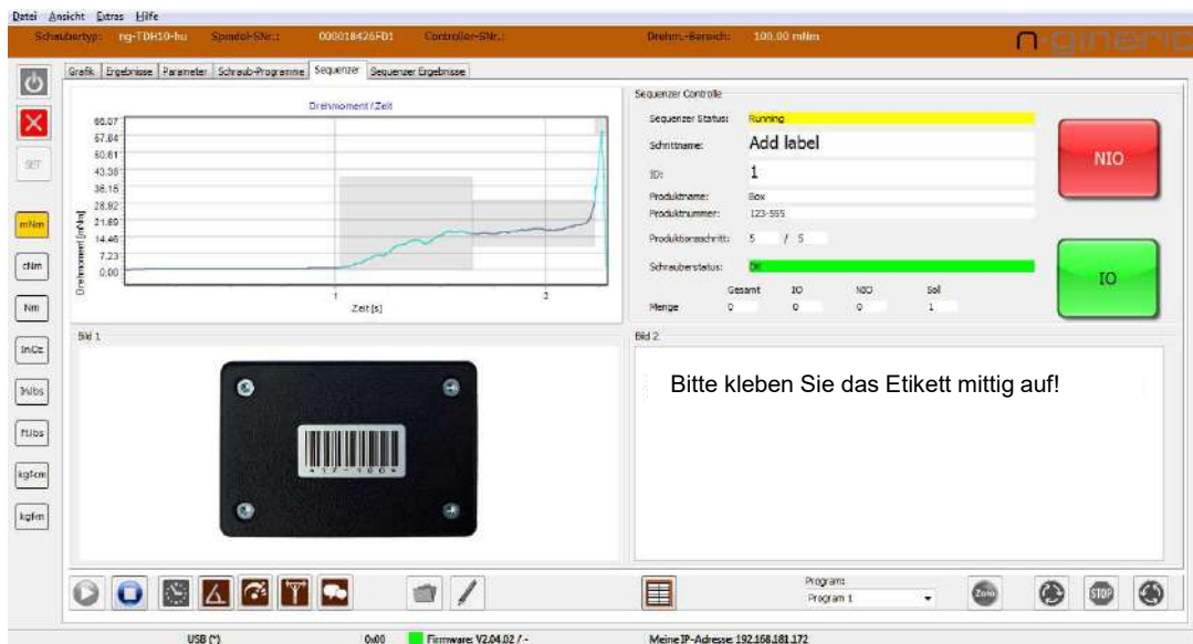
Beispielhafte Instruktionen an den Bediener bei frei definierbarem Montageschritt
