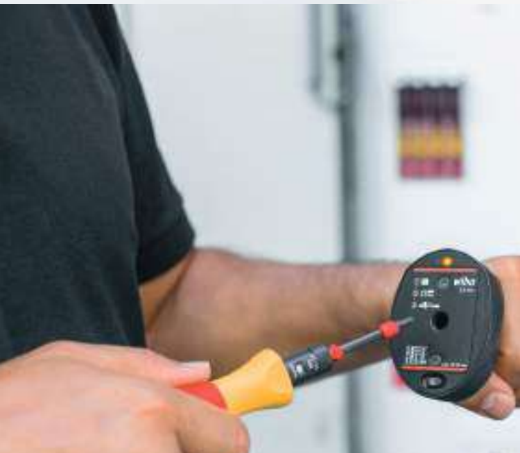
Mobile Überprüfung von Drehmomentwerkzeugen
