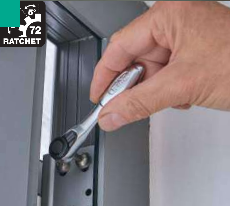
Feinverzahnte Mini-Ratsche mit rechts-links Lauf
