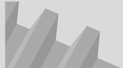
Schraube mit Trapezgewinde: Mehr Klemmkraft bei weniger Betätigungskraft.
