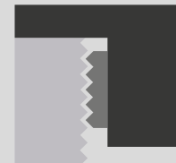
Mehrstufig einstellbare Gleitbacke.
