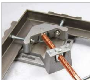
▶ mit Vorrichtung zur besseren Klemmung von Profilen
