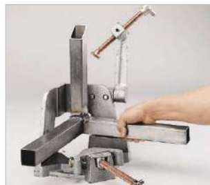
▶ der dritte Spannarm kann einfach weggedreht werden
