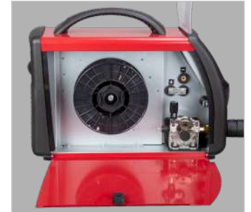
Im Innenraum umpolbar für Fülldrähte
