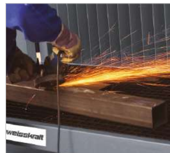
Hoher Schleifstauberfassungsgrad aufgrund der Rückwanderfassung
