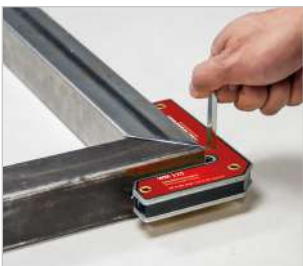
Sechskantloch zum Ablösen des Magnetwinkels.
