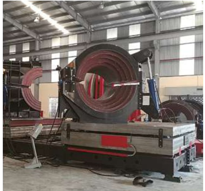
Manuelle Werkstattmaschine mit Werkzeug und Reduzierungen
