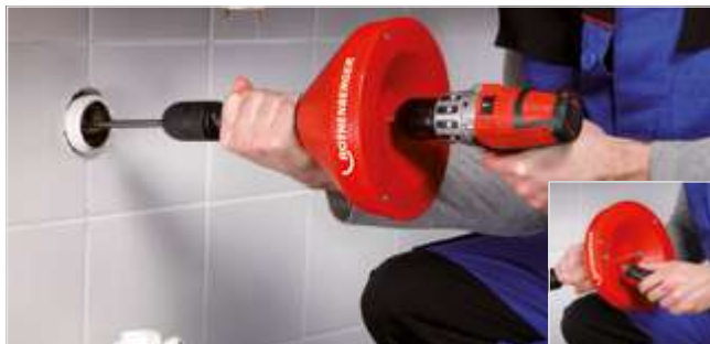
Einsatz mit Akkubohrmaschine
