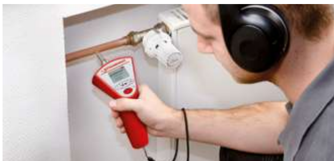
Akustische Leckageortung an Heizkörpern
