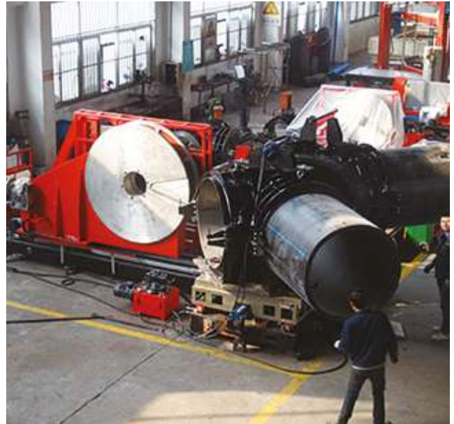
Herstellen eines Y-Stücks auf einer Werkstattmaschine
