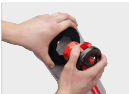
Werkzeuglose Speed-Lock Schneidkopfaufnahme
