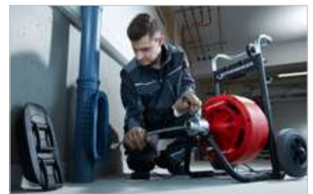
Reinigung eines Fallstranges mit 16 mm Spirale
