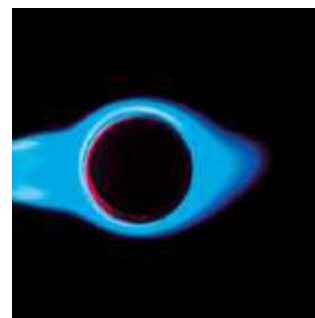
Hohe Flammentemperatur durch Zyklonverwirbelung
