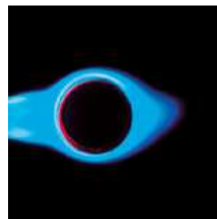
Hohe Flammentemperatur durch Zyklonverwirbelung
