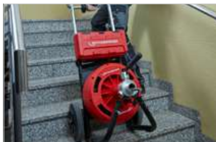
Einfacher Transport dank treppengängigem Fahrgestell
