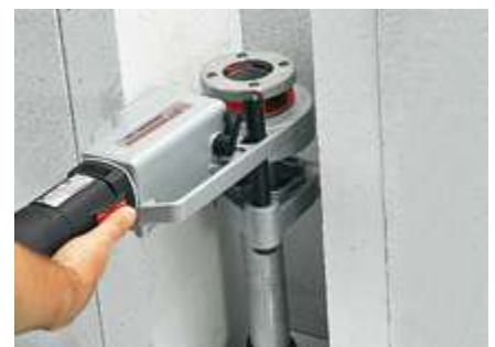
Arbeiten in beengten Stellen
