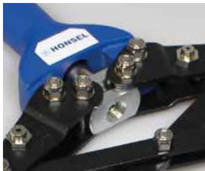
Wechselmundstücke im Werkzeug verschraubt.
