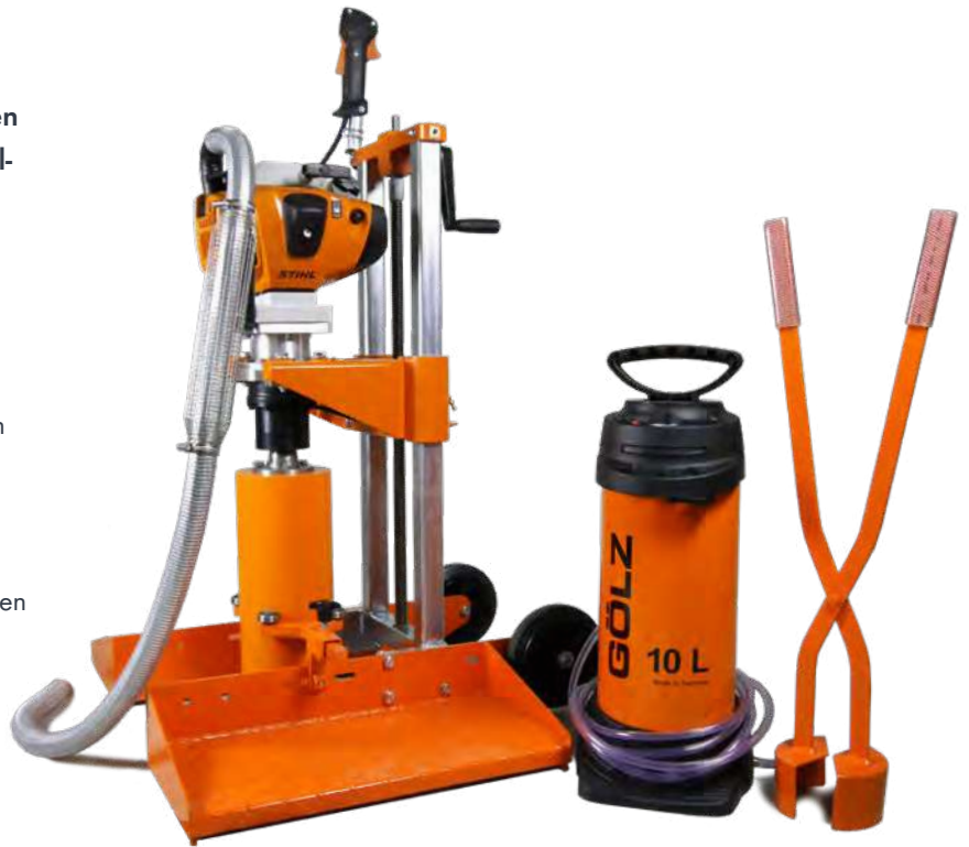
Bohren von Prüfkernen
