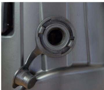
C- Rohr Anschluss für Abwasser
