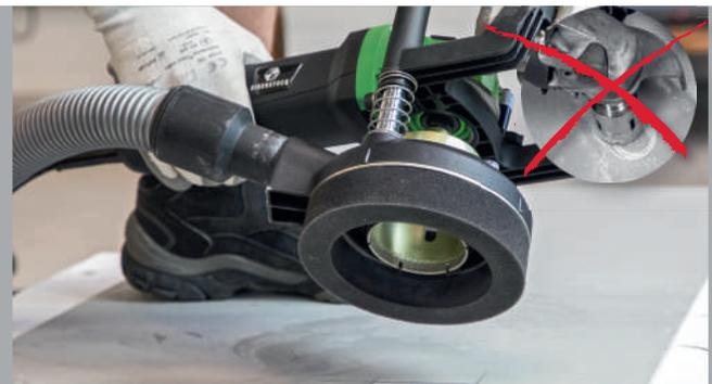
**Präzises Bohren durch rutschhemmenden Schaumstoff**
