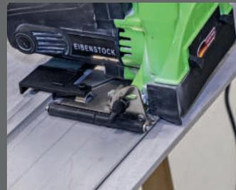
Schlitten mit Rollenführung – leichtgängiges Führen, schont die Werkstückoberfläche
