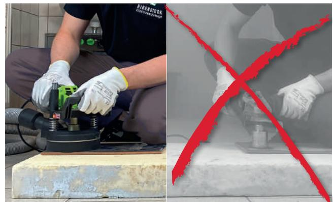
**Schutz des Anwenders vor gefährlichen mineralischen Stäuben** durch Absaugung, im Vergleich zu herkömmlichen Methoden mit Winkelschleifer
