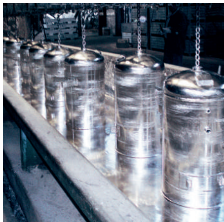
Feuerverzinkung für lange Lebensdauer liegend / stehend 50 Liter – 500 Liter 10 bar oder 15 bar
