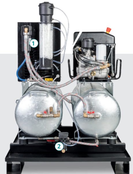
Ausstattung DUO KK zusätzlich mit: 1 Kondensataufbereiter zur Öl-Wasser-Trennung 2 Automatischer Kondensatableiter verbaut am Kondensatablass der Druckluftbehälter, Kondensatableitung ohne unnötigen Druckverlust
