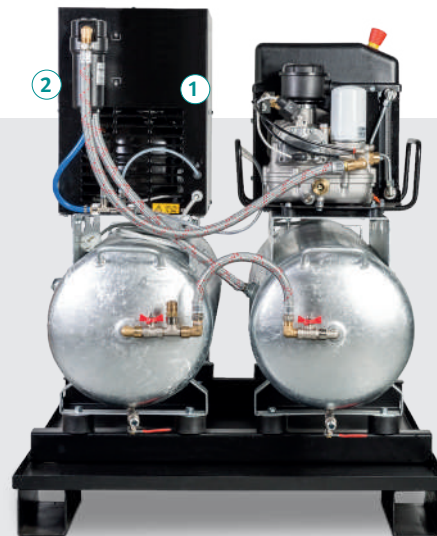
Ausstattung DUO K zusätzlich mit: 1 Kältetrockner mit integriertem automatischem Kondensatableiter: Drucktaupunkt 5 °C, Druckluft-Eintrittstemperatur 35 °C, Kühllufttemperatur 25 °C 2 Feinfilter als Vorfilter vor dem Kältetrockner zum Abscheiden von Kondensat und festen Verunreinigungen mit Partikeln bis 1 µm (Druckluftqualität nach ISO 8573-1)
