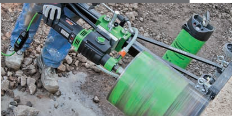
BST 352 V: auf vier Spezialkugeln gelagerter Schlitten
